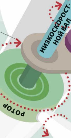
**2** Это самый дорогостоящий компонент ветряной турбины. Благодаря ему скорость вращения вала турбины возрастает с 15–40 до 1000–1800 об./мин. Этой скорости достаточно для нормальной работы генератора.
