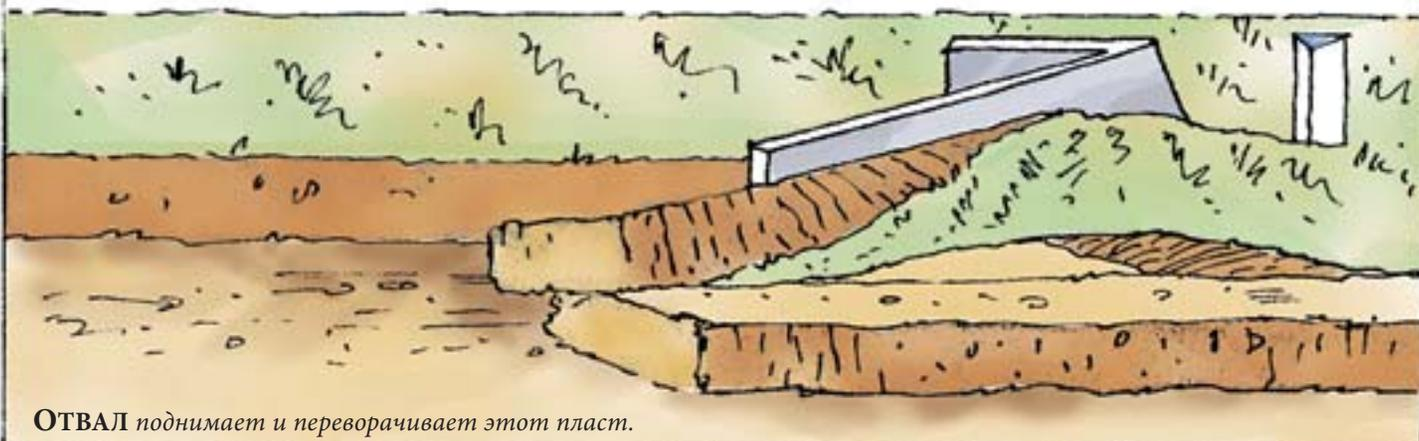
**ОТВАЛ** поднимает и переворачивает этот пласт.
