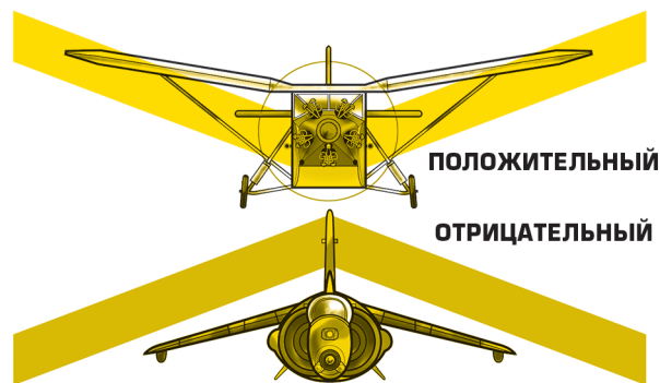
Рис. 8. Положительный и отрицательный углы поперечного изгиба плоскости крыла
