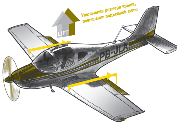
Рис. 14. Использование закрылков для увеличения несущей поверхности
