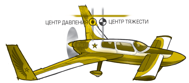
Рис. 4. И мотор, и крыло перемещены назад, что позволяет восстановить баланс
