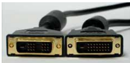
Рис. 1.4. Разъемы DVI-D с одинарной (слева) и двойной (справа) связью
