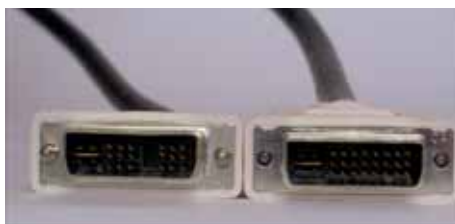
Рис. 1.5. Разъемы DVI-I с одинарной (слева) и двойной (справа) связью
