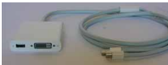
Рис. 1.6. Использование адаптера Apple Mini DisplayPort в Dual link DVI для соединения Mini DisplayPort компьютера с внешним монитором, имеющим порт DVI с двойной связью
