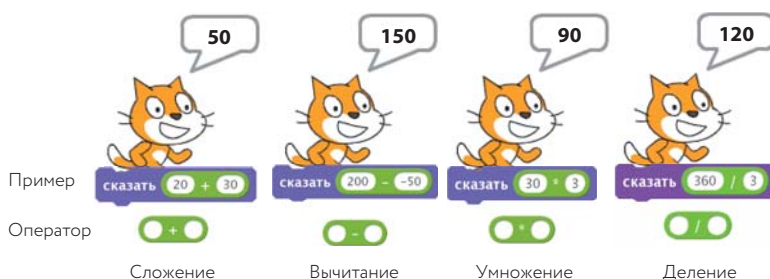
Рис. 1.27. Арифметические операторы в Scratch
