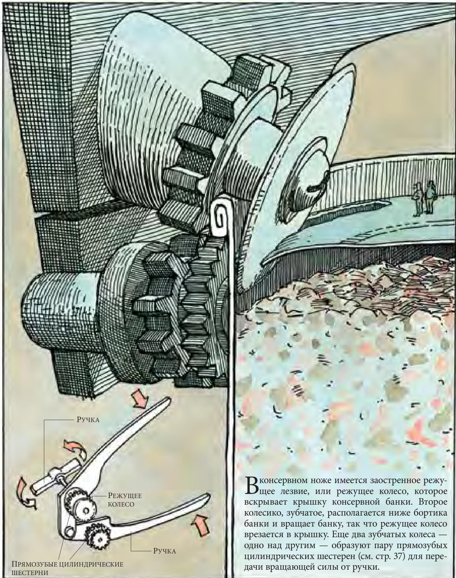
В консервном ноже имеется заостренное режущее лезвие, или режущее колесо, которое вскрывает крышку консервной банки. Второе колесико, зубчатое, располагается ниже бортика банки и вращает банку, так что режущее колесо врезается в крышку. Еще два зубчатых колеса — одно над другим — образуют пару прямозубых цилиндрических шестерен (см. стр. 37) для передачи вращающей силы от ручки.
