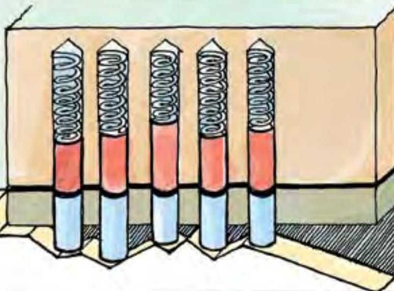
Ключ к решению этой загадки — это и есть ключ, так как блок представляет собой упрощенный цилиндрический замок. Зазубренная кромка ключа действует как набор клиньев, которые поднимают штифты, чтобы открыть замок. Так как зазубрины на ключе двусторонние, ключ можно вытащить после использования. Под действием пружин штифты вернуться в первоначальное положение, и замок закроется.
