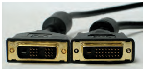
Рис. 1.4. Разъемы DVI-D с одинарной (слева) и двойной (справа) связью
