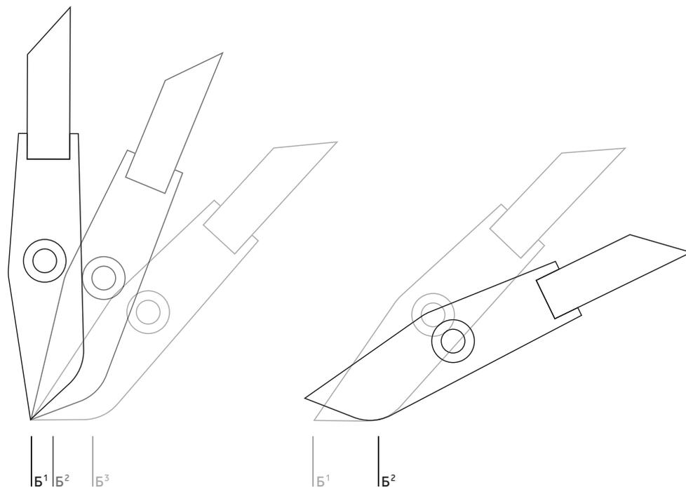
Толщину штриха можно варьировать в процессе работы, поворачивая пишущую грань насадки или меняя наклон держателя.
